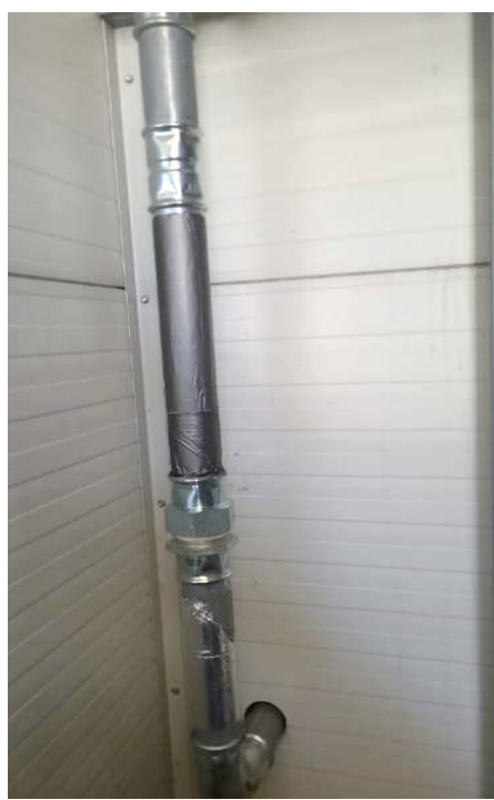
Obr. 3 a) Umiestnenie ultrazvukových senzorov na potrubí 1 b) Tlmiaca fólia interferenčných vln na potrubí.
