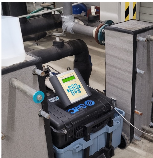
Obr. 5 Kontrolná jednotka FLUXUS G601 Meranie 1 (vľavo) a Meranie 2 (vpravo).
