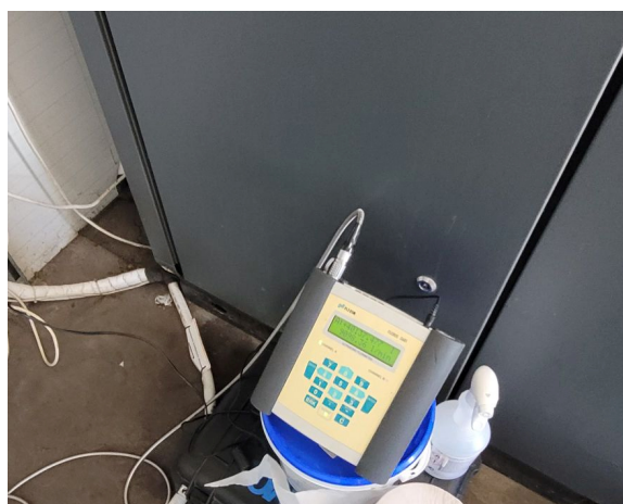
Obr. 5 Kontrolná jednotka FLUXUS G601 Meranie 1 (vľavo) a Meranie 2 (vpravo).
