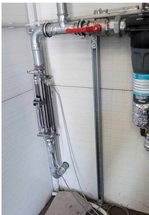
Obr. 3 a) Umiestnenie ultrazvukových senzorov na potrubí 1 b) Tlmiaca fólia interferenčných vln na potrubí.
