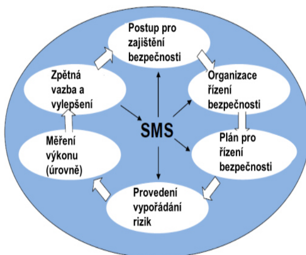
Obr. 4. Úkoly uvedené v systému řízení bezpečnosti (SMS) objektu.
