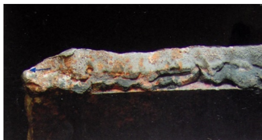
Obr. 6. Vzhled povrchu roztrženého podélného sváru v oblasti styku s obvodovým svarem. Šipkou je vyznačena poloha dna sváru A; šířka odlomené části 3.5 mm.
