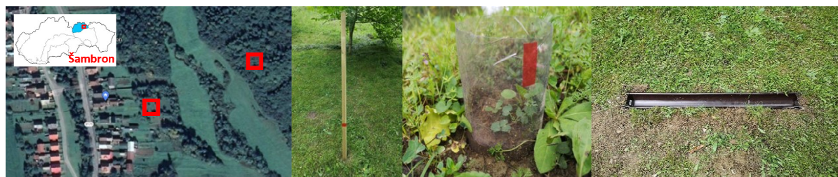
Obr. 1 - Sledované územie a monitorovacie zariadenia – erodomerná tyč, erodomerný valec a Gerlachova priekopa.
