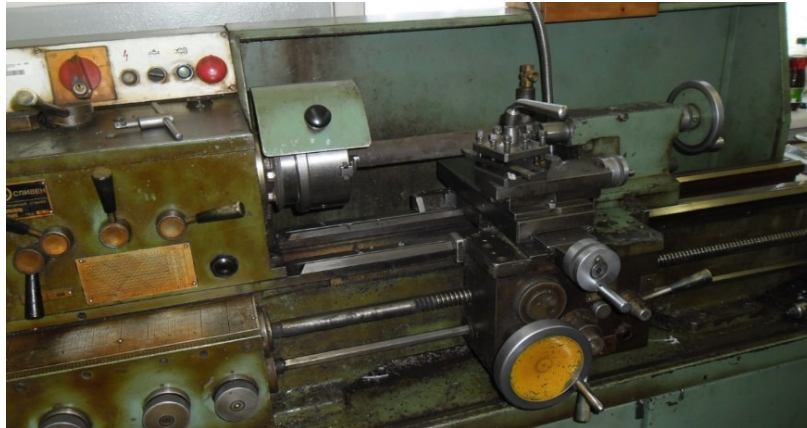
Obr. 3 - Predná časť hrotového sústruhu C8C na spracovanie kovov.
