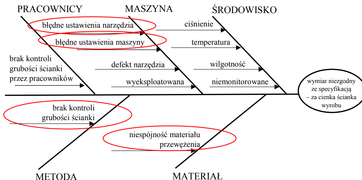
Rys. 5. Przykład wykorzystania diagramu Ishikawy do rozwiązania problemu niezgodności wymiaru ze specyfikacją.
